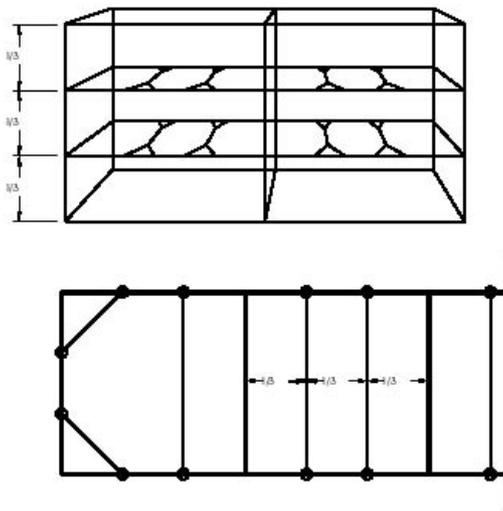
1.8. За один раз заполняют только 1/3 габиона. Затем фиксируют габион изнутри горизонтальной связкой поверх слоя камня. Затем фиксируют вторую треть габиона, и, наконец, его последнюю треть до верха. Полуметровые габионы заполняют в два приема. Матрасы Рено толщиной 170, 230, 300 мм заполняются в один прием, без связывающих скоб.
