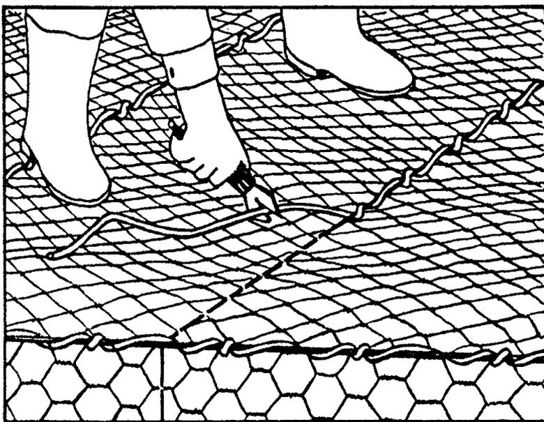
2.8. После заполнения матраса, укрепите его крышку в углах и надежно привяжите ее к верхним частям диафрагм и боковых панелей. Связка ведется с чередованием двойных и одинарных петель, как это было показано для коробчатых габионов. При наличии нескольких уже заполненных матрасов
