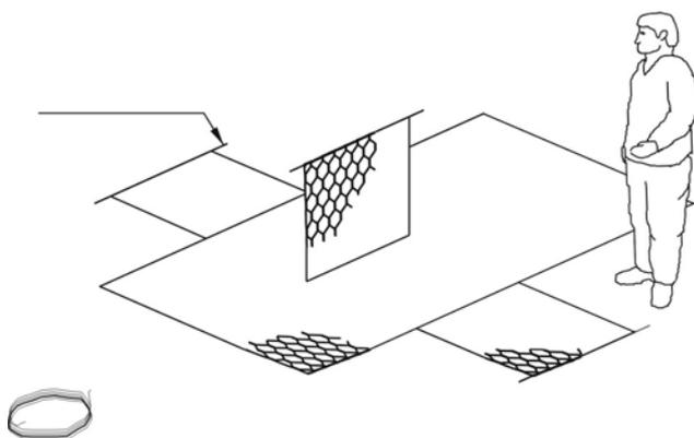
1.2. Разложите габрион на твердой плоской поверхности и расправьте все складки
