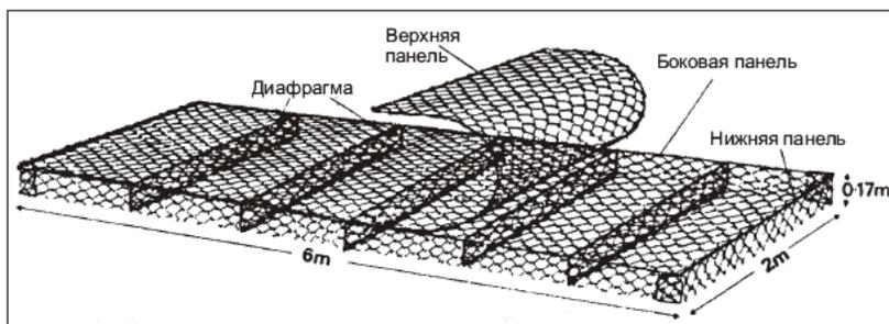
2.3. Поднимите вертикально боковые панели и диафрагмы. Проверьте, чтобы высота обеих боковин была одинаковой.
