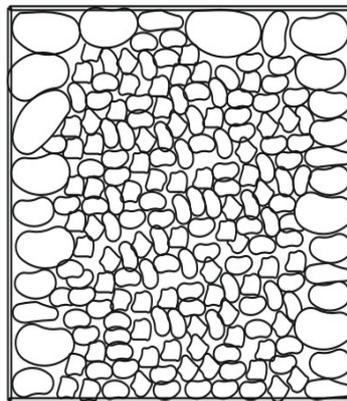
1.6. Для заполнения габионов используется камень-заполнитель размером 125-200 мм (но не более 250 мм). Минимальный размер камня должен быть не меньше размера сетки. Допускается присутствие 5-7 % камня
