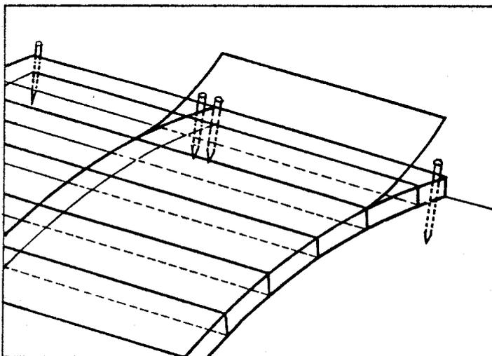
2.11. В случае, когда матрасы укладываются на крутых склонах (откос более чем 1:1,5), они должны быть надежно прикреплены деревянными кольями (сваями) к грунту на вершине откоса через каждые два метра или через необходимое расстояние. На песчаных склонах, или склонах,
