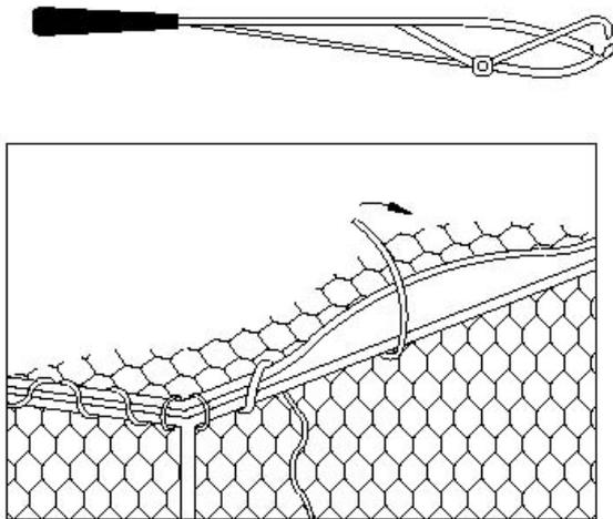
1.10. Крышку габиона необходимо плотно притягивать к верхним краям габиона и одновременно увязывать проволокой. Сначала необходимо сделать временную (предварительную) привязку углов, чтобы не происходило сдвига сетки по периметру верха габиона. Если камень-заполнитель мешает плотной притяжке крышки, то некоторое его количество может быть перемещено в центральную часть габиона.
