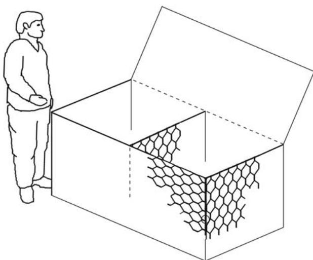
1.3. Согните лицевую, заднюю и боковые панели в вертикальную позицию, сформировав прямоугольный ящик. Соедините вершины углов ящика вместе с толстой проволокой кромки, торчащей из углов каждой панели. Убедитесь, что верхние части всех четырех сторон ящика находятся на одном уровне.
