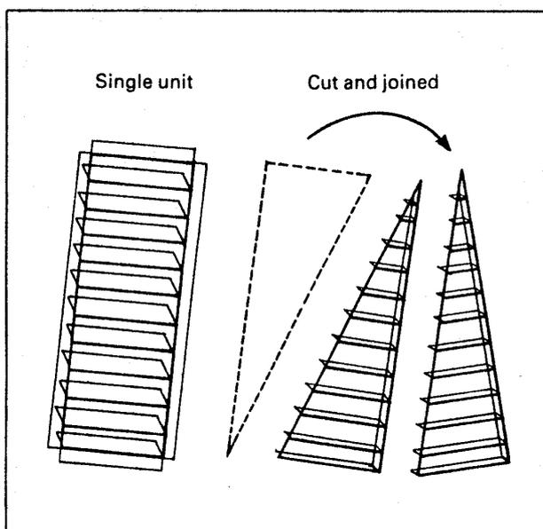
2.9. Для устройства криволинейных участков сооружений матрасы Рено могут быть разрезаны двумя способами.
