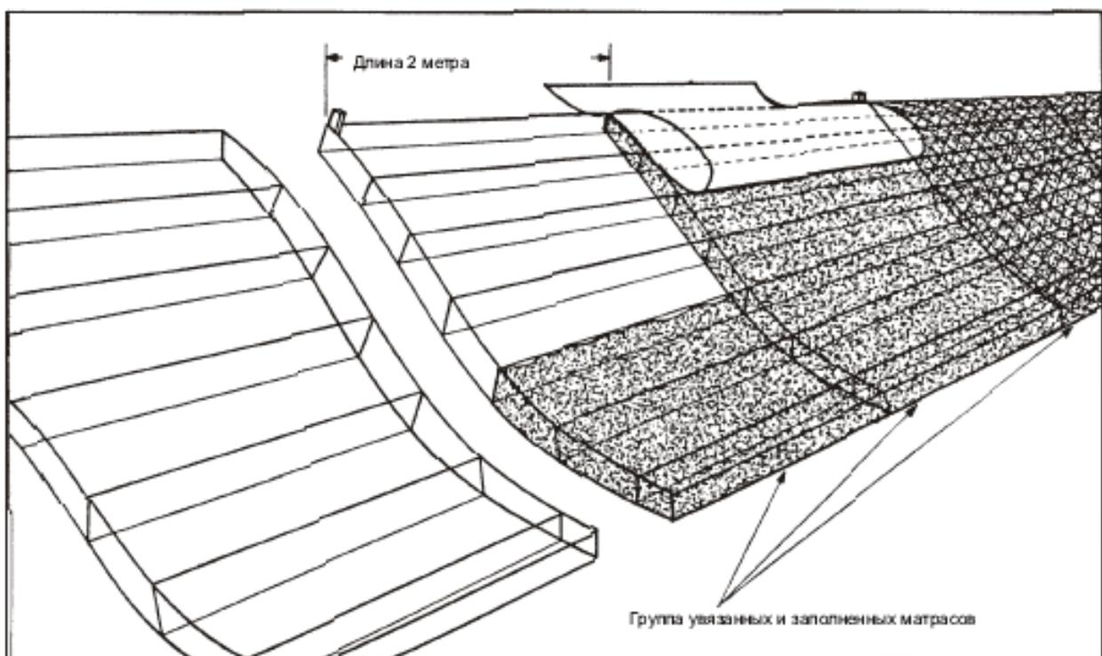
Укладка должна производиться очень осторожно, нельзя допускать прорыва геотекстиля проволокой.
