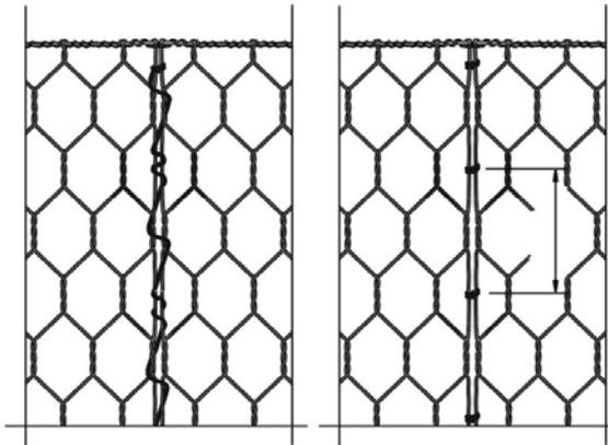
1.4. Начинайте связывать вершины углов панелей проволокой для связки, соединяя панели вместе витками, как показано на рис.4. Перевязку производят, чередуя одну петлю и две петли через 100 мм
