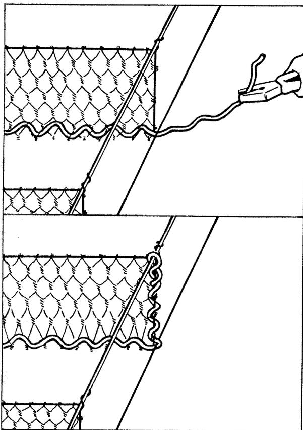
2.5. Возьмите конец проволоки, которой привязана диафрагма к днищу габиона, проташите его на себя и используйте этот конец для привязки диафрагмы к боковине. Протаскивайте столько проволоки, сколько необходимо для привязки диафрагмы к боковине. Привязка должна производиться непрерывной проволокой, а не отдельными связками.
