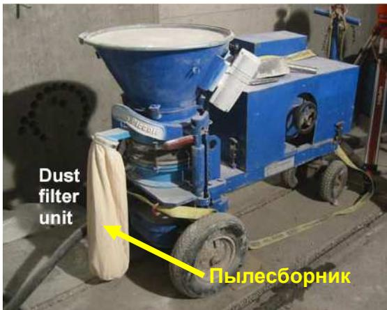
Машина для сухого метода торкретирования серии Meuco Piccola или аналогичное оборудование должны быть оснащены фильтром для сбора пыли или аналогичной пылесборной системой, как показано выше, (см. рис).
